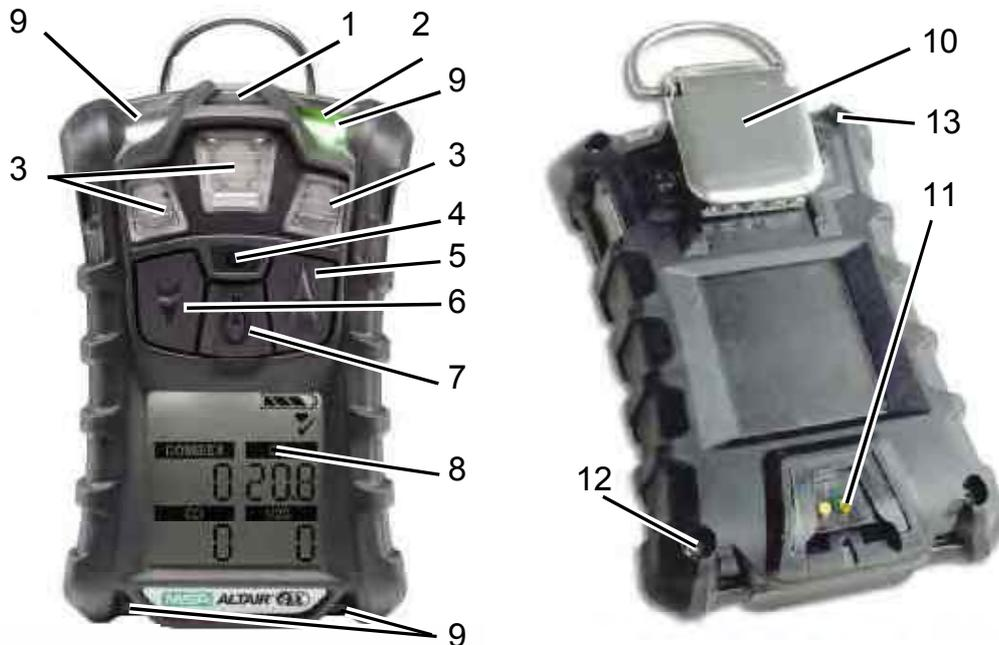
Bild 1 Übersicht über das Gerät
